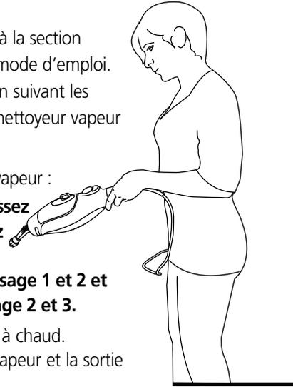
3) Une fois l'appareil assemblé et rempli d'eau, brancher le cordon d'alimentation sur une prise de terre. Le voyant rouge d'alimentation indique quand l'appareil est branché. L'interrupteur (O/I) de mise en marche est en position OFF (O) (position du haut). Attendre que le voyant passe au vert, environ 20 à 30 secondes. Le voyant passe au VERT lorsque le balai vapeur est prêt à l'emploi.
